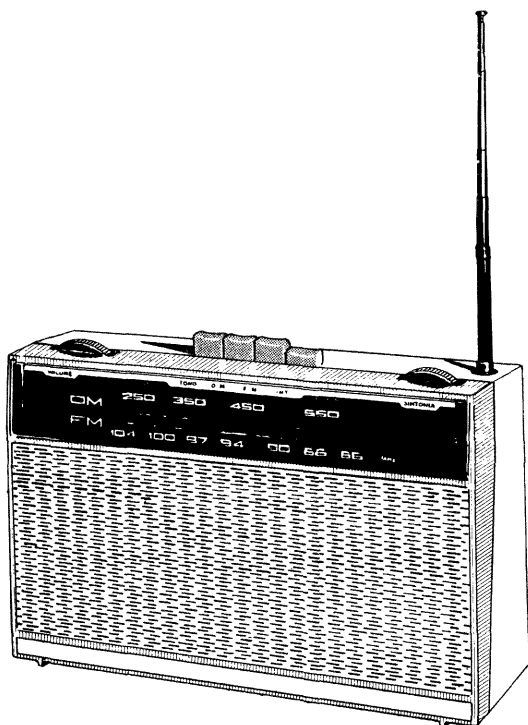
Fig. 15.15 - Apparecchio ad onde medie e a modulazione di frequenza, con 9 transistor e 4 diodi. È provvisto di due antenne, una magnetica e una telescopica, nonché di commutatore a quattro tasti.
