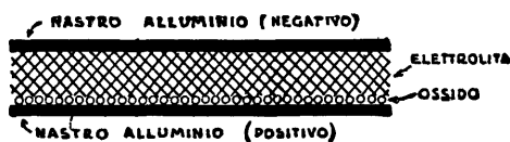
Fig. 3.8 - L'ossido di alluminio è presente sul nastro positivo ed è mantenuto dall'elettrolita.
